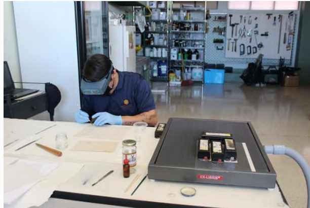
Fotografía 2. intervención de los documentos: resanes y secado en la mesa de succión.
