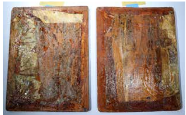
Reblandecimiento de cola con gel de metil celulosa
