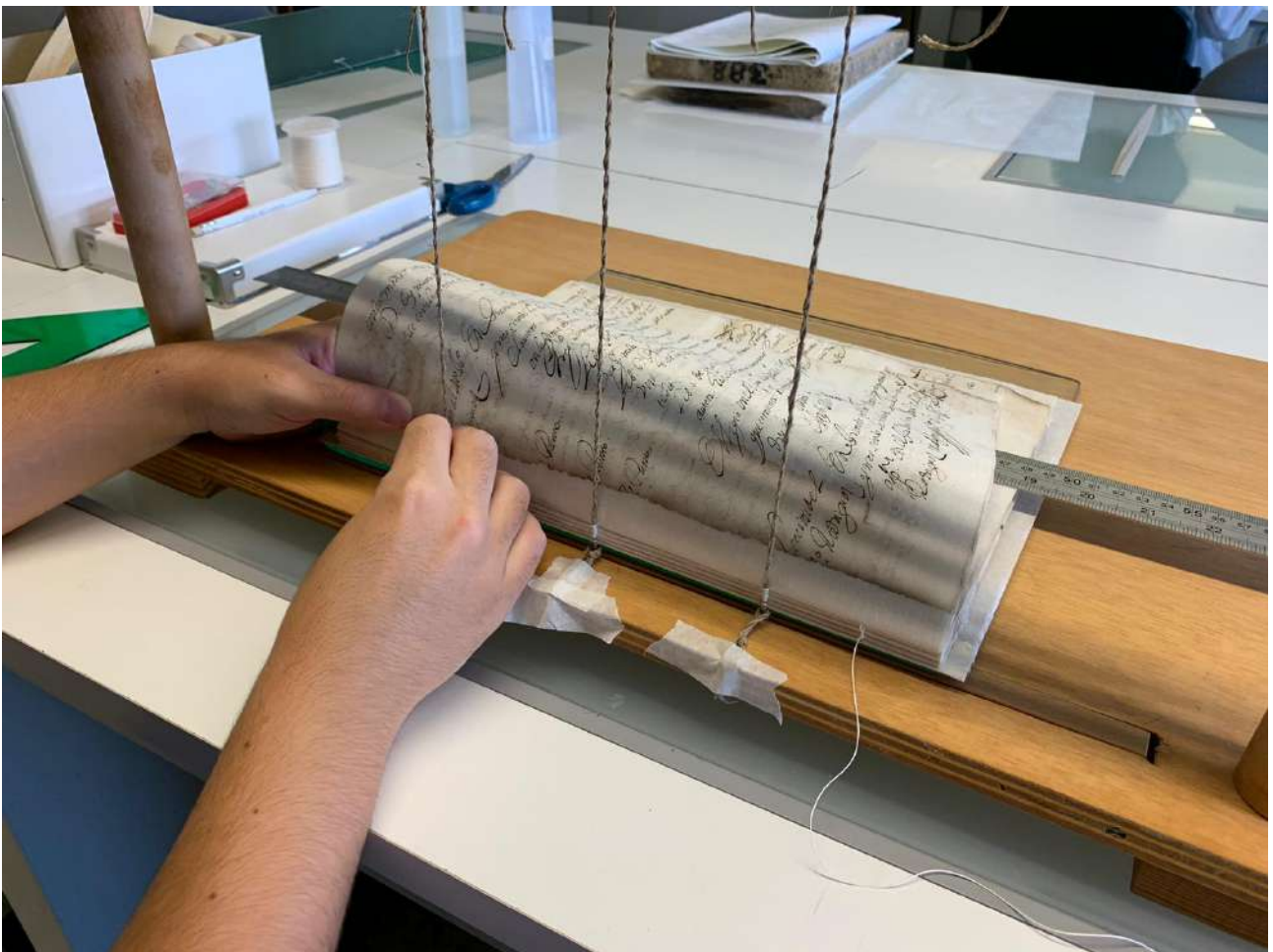
Ilustración 4: Cosido con nervios de bramante.
