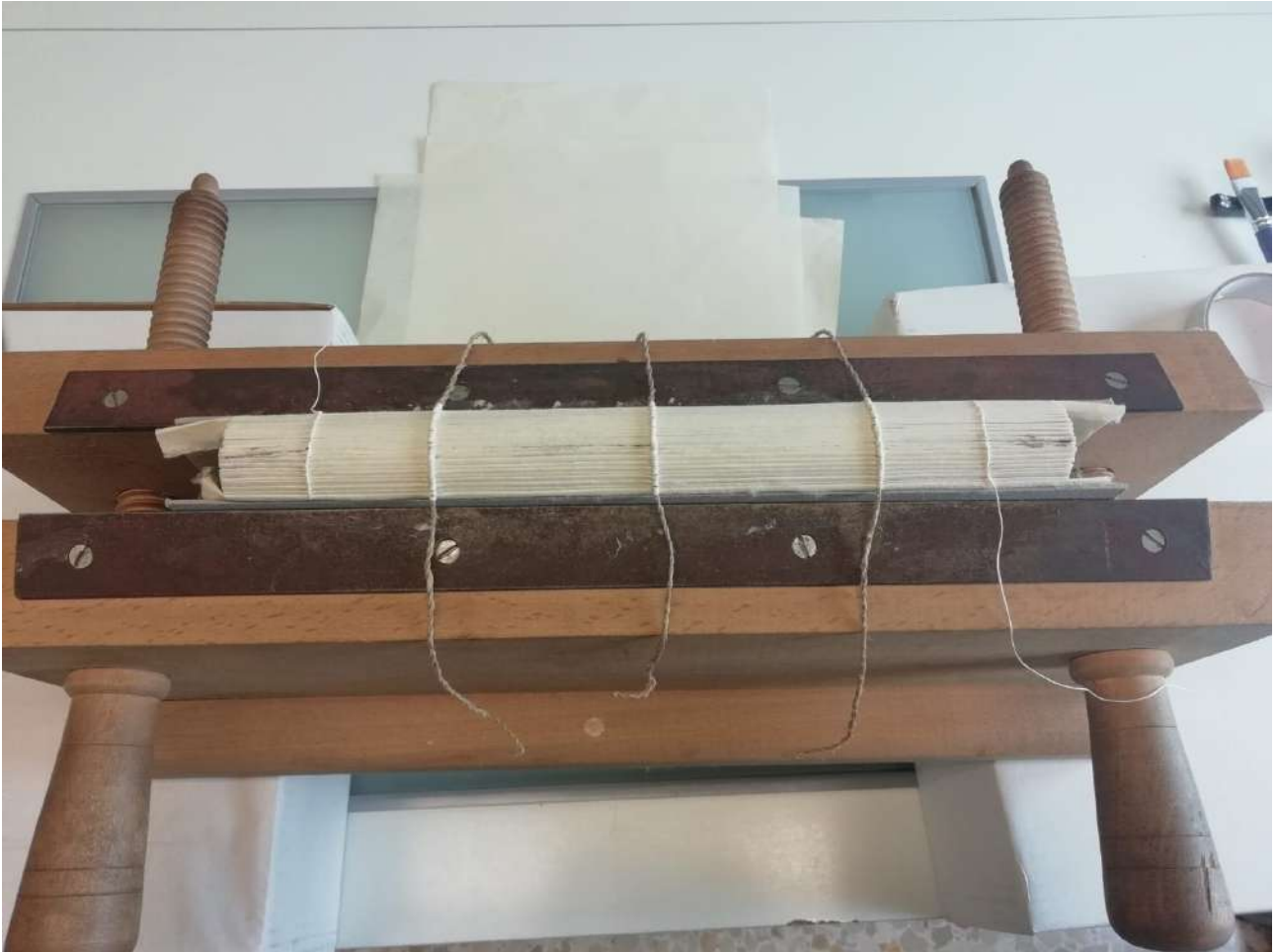
Ilustración 7: Preparación del enlomado
