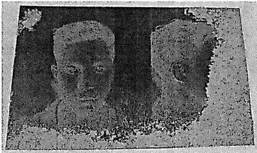
Ilustración 37. Negativo de acetato de celulosa con material adherido a la superficie. Imagen: Ixchel Landa.
