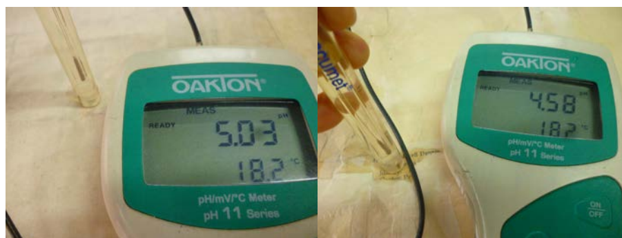
FOTO 2. MEDICIÓN DE pH SOBRE ANVERSO DE LA OBRA - TELA (IZQ.), pH SOBRE INJERTO DE INTERVENCIÓN ANTERIOR (DER.).
